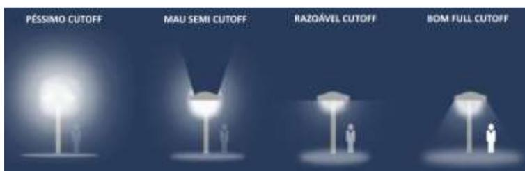
**Figura 62** - Tipos de Controlo Rácio de Saída do Fluxo Luminoso Ascendente (ULOR) [23]
