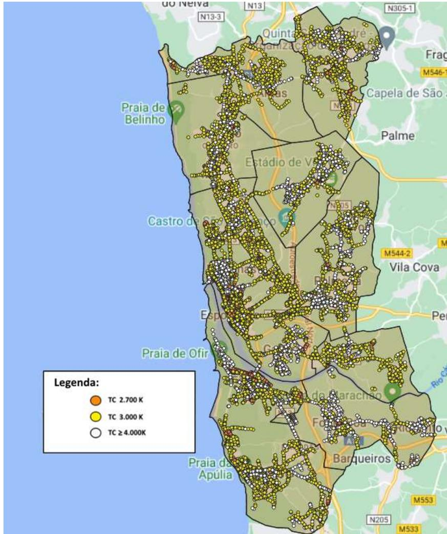
**Figura 54 – Mapeamento da Temperatura de Cor no Município de Esposende**
